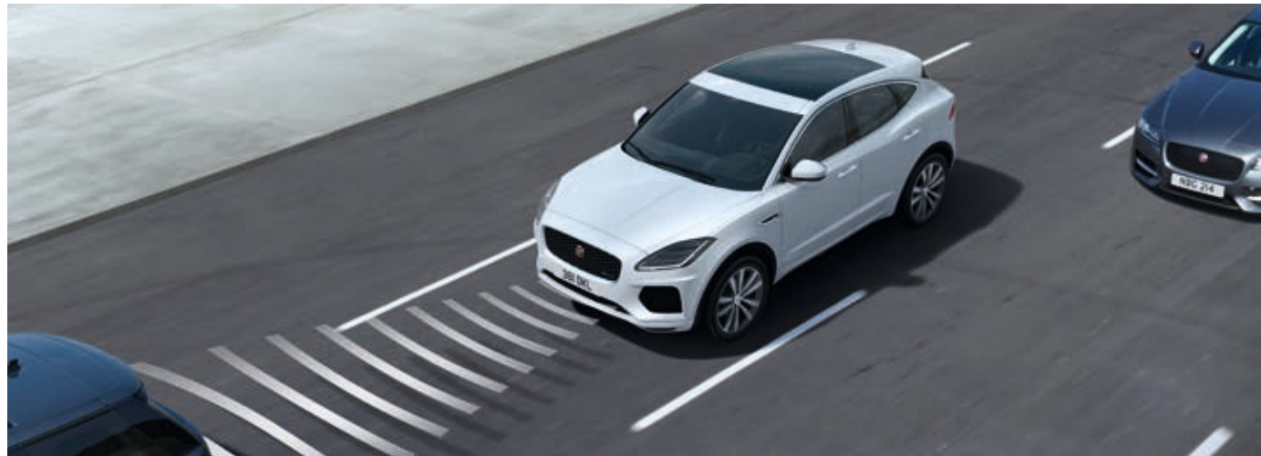
Control de velocidad adaptable con ayuda en cola
