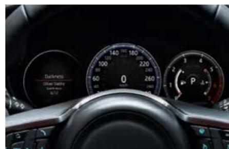
Panel de instrumentos con pantalla de 12,3" totalmente digital con diales virtuales
