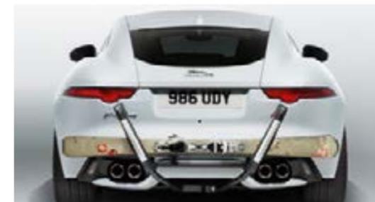
**Portaesquíes montado en la parte trasera**
