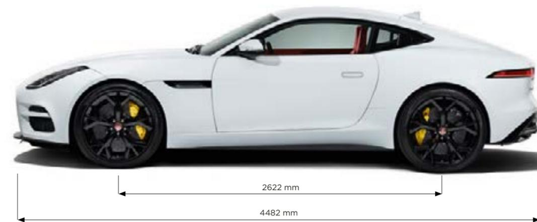
Se tomaron las dimensiones del vehículo con peso en vacío. (Medido con el método de prueba estándar VDA con bloques de 200 x 100 x 50 mm). Las cifras indicadas corresponden al F-TYPE R. Consulta las páginas 106 y 107 para obtener más detalles sobre las especificaciones técnicas.
