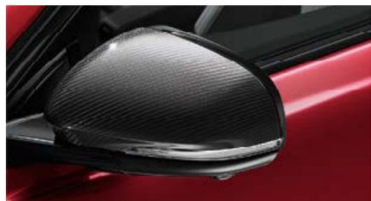
**Cubierta de retrovisores de fibra de carbono**
