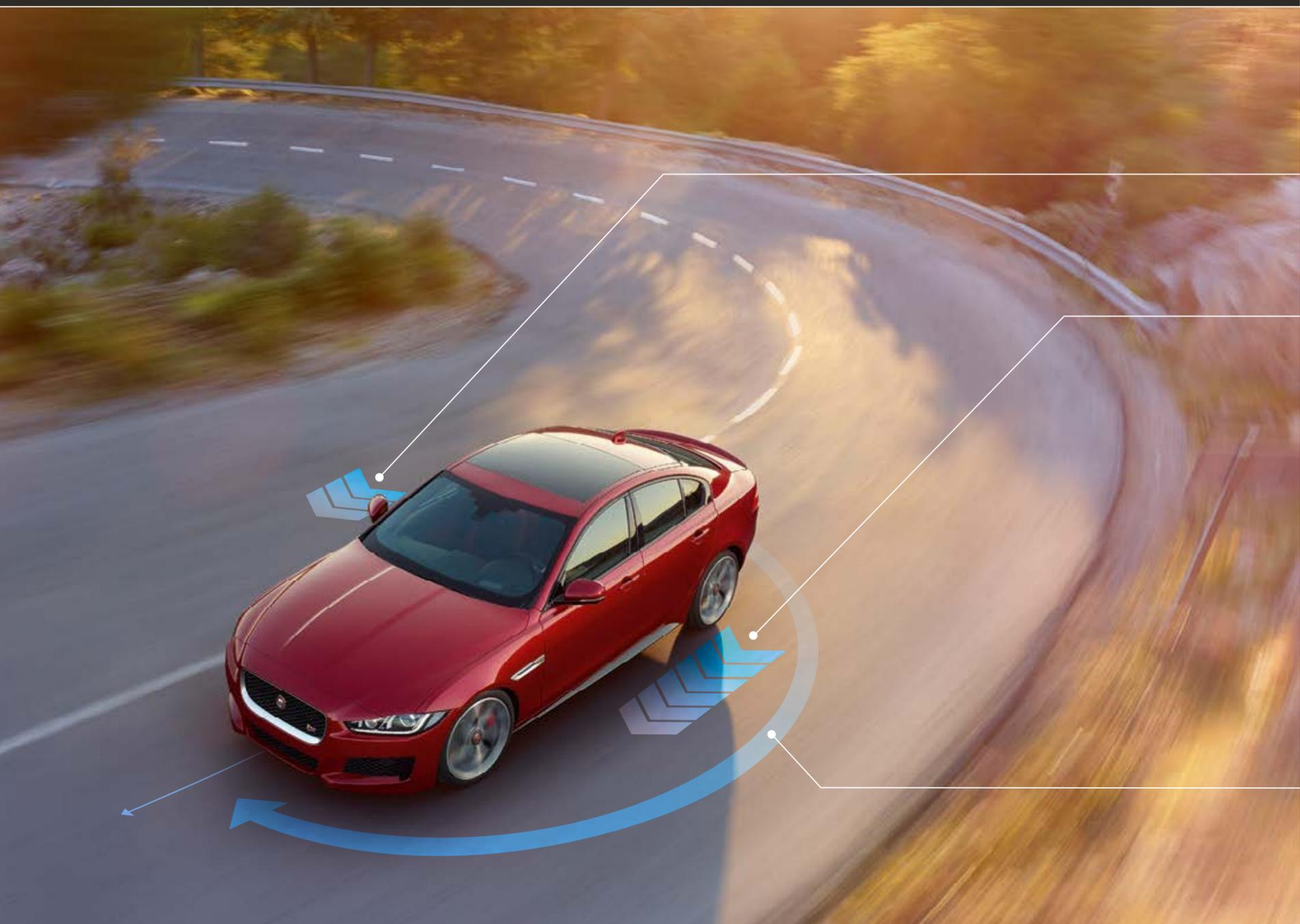
LA VECTORIZACIÓN DE PAR APLICA PRESIÓN DE FRENADA PARA RALENTIZAR INDEPENDIENTEMENTE LA PARTE INTERIOR DE LAS RUEDAS DELANTERAS Y TRASERAS.
