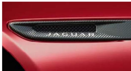
**Entrada de aire lateral eléctrica de fibra de carbono**
